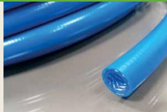
Mehrschichtiger PUR-Schlauch, innen transparent, außen blau mit Polyesterfadeneinlage. Geprüft und zugelassen nach: DVGW W270, VP 549, KTW A kalt, UV-beständig.
