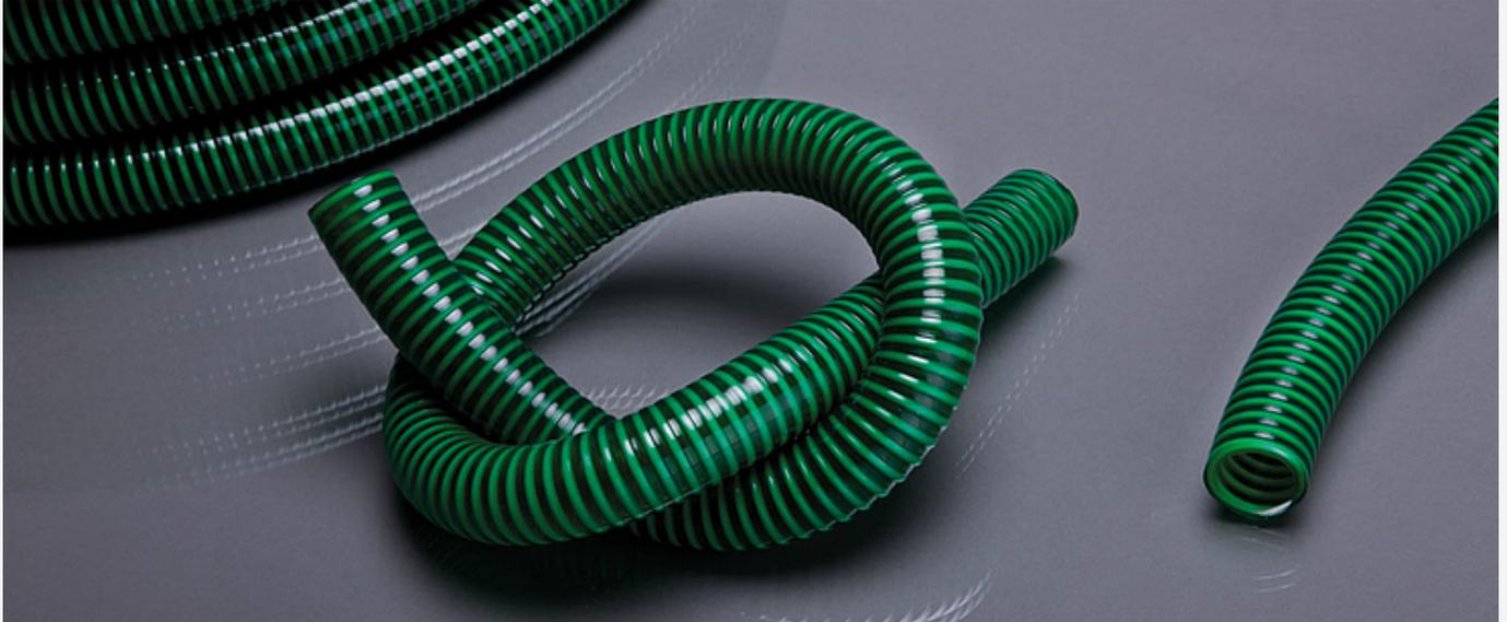
Hochflexibler und handlicher PVC Schlauch verstärkt mit einer schlagfesten Hart-PVC-Spirale. Die völlig glatte Seele gewährt geringen Druckverlust und garantiert höchstmöglichen Durchfluss. Die leicht gewellte Decke bietet ein optimales Biegeverhalten. Geeignet für eine Vielfalt von chemischen Substanzen.
