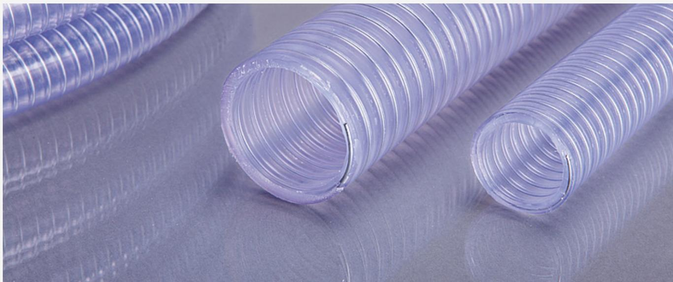
Flexibler Saugschlauch aus Weich-PVC verstärkt mit einer Federstahlspirale, innen und außen glatt. Freigegeben für Lebensmittel entsprechend der europäischen Richtlinie EU 10/2011 A, B, C und D1 (Milch).
