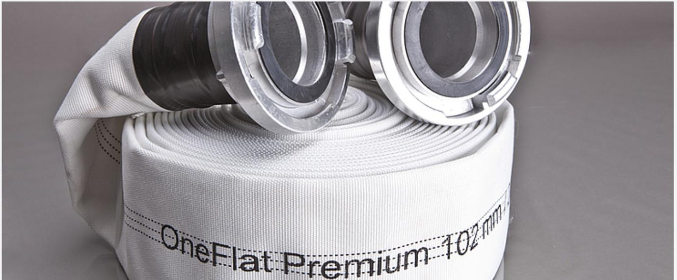
Bauflachschlauch aus Polyester-Gewebe, innen EPDM-beschichtet. Fertig eingebunden mit APD Connect Aluminium Storz-Kupplungen. Endenschutzmanschetten. Sehr hohe Druckfestigkeit, gute Abriebfestigkeit, sehr robust. Andere Längen und Durchmesser auf Anfrage. Verpackung: einzeln im Karton.
