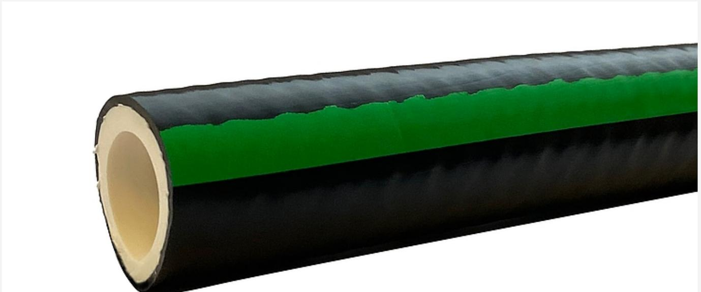
PVC Saug- und Druckschlauch mit Federstahlspirale und hochreißfestem Kreuzgewebe aus Polyestergarn für bis zu 14 bar Betriebsdruck. Zur Förderung von Wasser, Abwasser, Fäkalien, nicht korrosiven Flüssigkeiten und vielen chemischen Substanzen.
