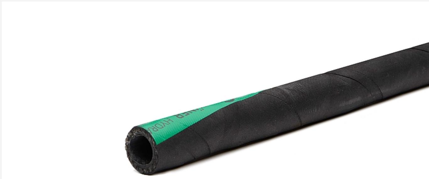
Vielzweck-Gummischlauch mit 16 bar Betriebsdruck. Zur Förderung von Kohlewasser- und Kraftstoffen mit einem Benzolgehalt <50%. Rückführung von Öl und Fett inhydraulischen Kreisläufen sowie wässrige Lösungen, Meerwasser und geeignet zur Ausrüstung von Hochleistungsfarbspritzanlagen.
